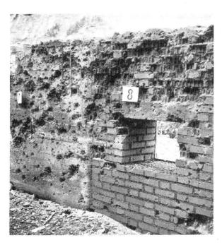
Splitterwirkung auf armierte Betonwand (links) und auf Backsteinmauer (rechts). Die nur 17,5 cm dicke Eisenbetonwand wurde durchschlagen, die Backsteinmauer erhielt Einschläge bis zu Tiefen von 19 cm. Presse Diffusion Lausanne
