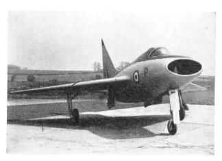
Forschungsflugzeug BOULTON-PAUL, Type P. 111 Dieser Prototyp eines brit. «fliegenden Dreiecks» fällt auf durch seine kurze, gedrungene Bauweise. Es ist bekannt geworden wegen seiner erstaunlichen Wendigkeit. Auch dieser Dreieckflügler besitzt den Brems-Fallschirm.
