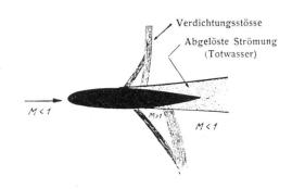
Abb. 2. Flügelprofil mit lokaler Ueberschallströmung
