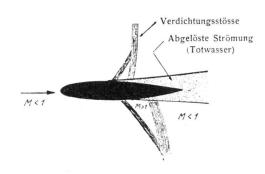
Abb. 2. Flügelprofil mit lokaler Ueberschallströmung
