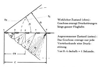
Abb. 1. Vordringen des Geschosses und der Druckstörungen
