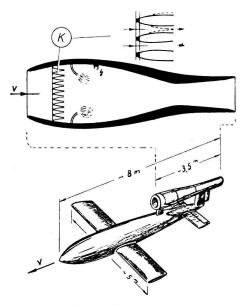
Abb. 7. Flügelbombe V 1 mit Zweitakt-Staudüse (Fluggeschwindigkeit 500-600 km/h)
