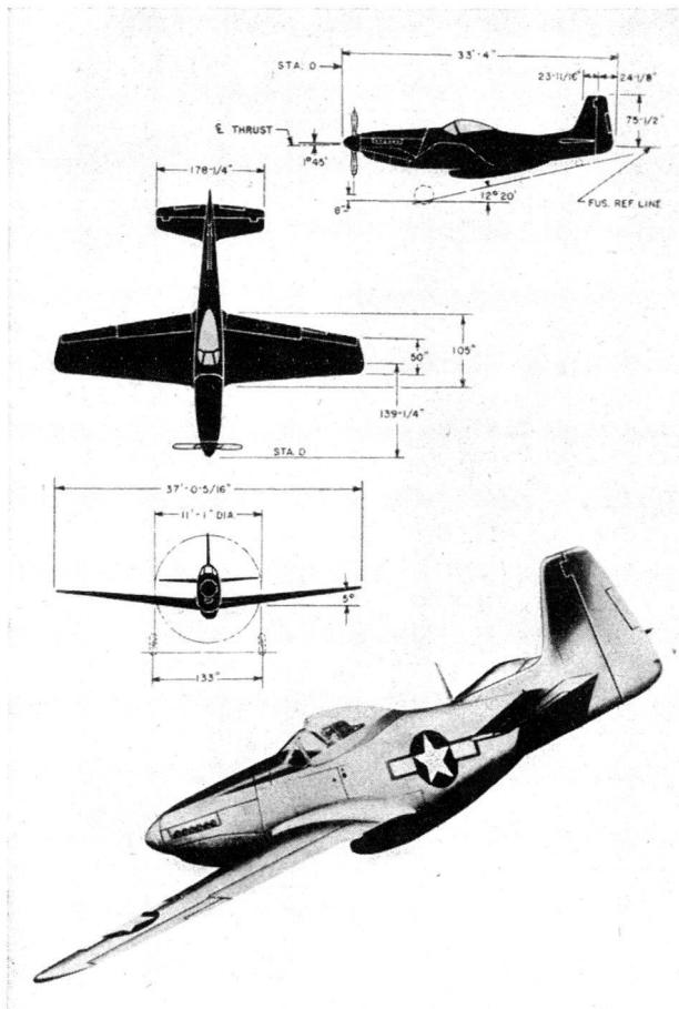
mehr gewachsen. Heute noch zählt der North-American-Mustang mit seiner Höchstgeschwindigkeit — die bis an die 700-km-Grenze heranreicht — zu den besten und schnellsten Jagdflugzeugen mit Propeller/Kolbenmotorantrieb. Neben seiner starken Bestückung mit Bordwaffen (sechs schwere Maschinengewehre 12,7 mm, 950 Schuss/Minute und einer Dotation von 250 Schuss pro Lauf) kann dieser Jäger überdies noch zwei mittlere Bomben von je 250 kg mitnehmen (unter den Flügeln an-
