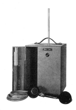
2. Hasler-UKW-Mehrkanal-Kleingerät, Typ 1940
