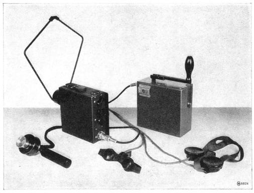
3. Hasler-UKW-Zweikanal-Kleingerät, Typ 1944
