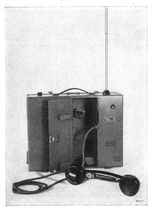
4. Hasler UKW-Mehrkanal-Kleingerät, Typ 1946 (ersetzt Gerät, Typ H 207, Pos. 2) ellenbereich: 4,7—5,3 m (64—56 MHz). istung: zirka 0,25 Watt. triebsart: Telephonie
