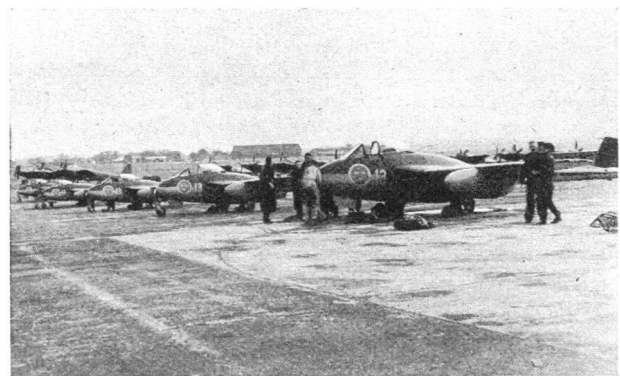
Abb. 3. Fünf für die schwedische Luftwaffe ablieferungsbereite «Vampir»-Rückstossjäger auf dem Werftflugplatz von Hatfield. Nahe am Rumpf dieser Düsenjäger (bei der Zahl 13) sind die Eintrittsöffnungen (linksseitige) für die zum Antrieb benötigten riesigen Mengen an Aussenluft sichtbar.
