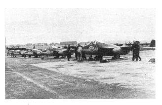
Abb. 3. Fünf für die schwedische Luftwaffe ablieferungsbereite «Vampir»-Rückstossjäger auf dem Werftflugplatz von Hatfield. Nahe am Rumpf dieser Düsenjäger (bei der Zahl 13) sind die Eintrittsöffnungen (linksseitige) für die zum Antrieb benötigten riesigen Mengen an Aussenluft sichtbar.
