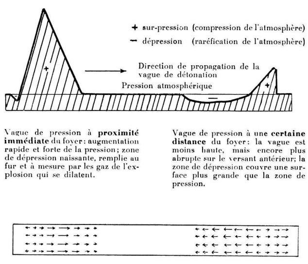
Les flèches indiquent les mouvements de l'atmosphère causés par l'explosion. La longueur des flèches est proportionnelle à la vitesse des courants aux différents endroits.
