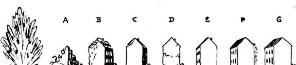
*Effets de la détonation d'une bombe sur un bâtiment, en fonction de la distance.*
