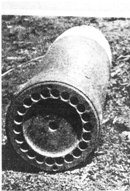
Düsen- und Zündöffnungen eines 21-cm-Raketengeschosses.
