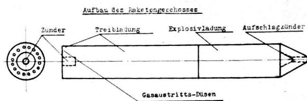
Das Raketenabschuss besteht aus dem eigentlichen Granatteil oder Sprengsatz und dem Treibsatz, welcher vor oder hinter dem Sprengsatz angeordnet ist.
