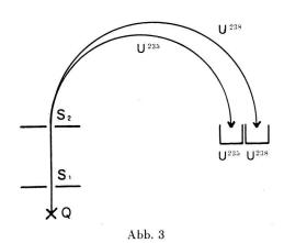
Schema der elektromagnetischen Isotopentrennung
