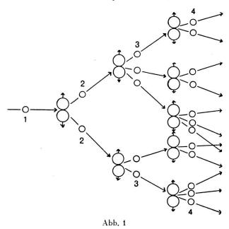
Lawinenartiges Anschwellen der Kettenreaktion, schematisch.
