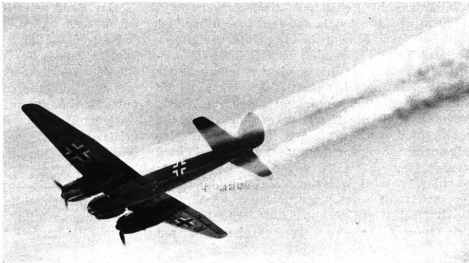
Langsam und hauchdünn beginnt bei der Ju 88 die Bildung der Kondensstreifen in Höhe des Leitwerkes. Immer mehr verdichten sich die Streifen, bis schliesslich eine dicke Nebelwolke entsteht.
