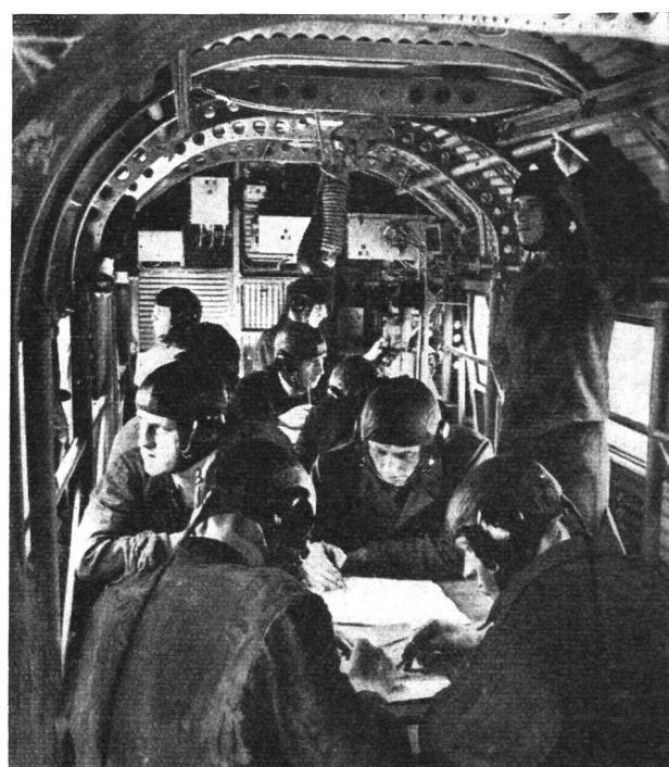
Blick in den Kabinenraum eines Ju-52-Hörsaalflugzeuges. Der «Fliegende Theoriesaal» gestattet während des Fluges den praktischen Unterricht über alle fliegerrischen, navigatorischen und funktechnischen Fragen und zeigt wesentliche, erfolgsichere Vorteile gegenüber allen theoretischen Lehrmethoden.
