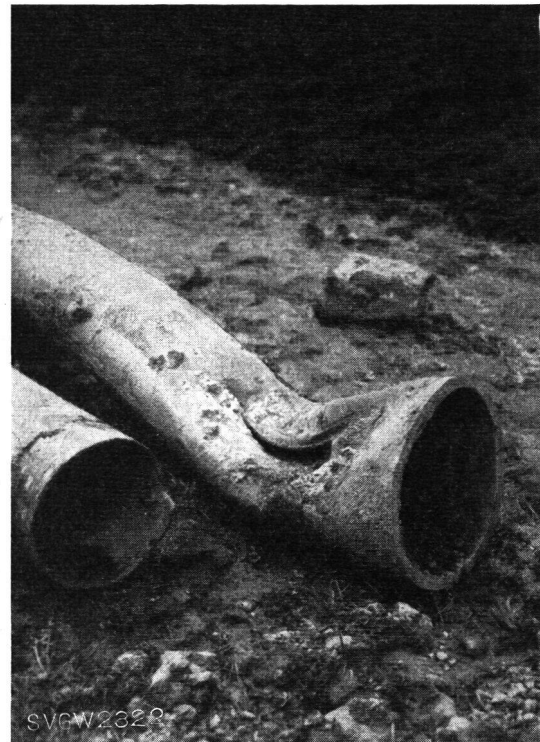
Abb. 6. Stokargässchen, Sprengbombeneinschlag. Mm.-Wasserrohr 250 mm Ø.
