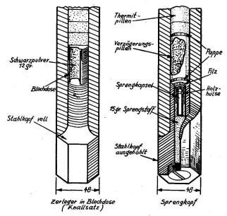
Neue Bombenköpfe bei der britischen Stabbrandbombe. - Zur Einschüchterung der Löschkräfte baut der Gegner häufig Schwarzpulver-Knallsätze (Zerlegerladungen) oder Sprengköpfe mit Spreng- oder Splitterwirkung in die Stabbrandbomben ein. Die Löschkräfte müssen die Brandbekämpfung daher in der Regel stets von einer Deckung aus (Mauer, Schornstein o. ä.) durchführen.
