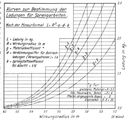
berechnet. L= Ladung in kg, R= Wirkungsradius in m, g= Materialkoeff. (für Wände in Bruchsteinmauerwerk 3—4, für Pfeiler 5), d= Verdämmungsziff. (für Verdämmung mit sandigem, feuchtem Lehm durch Versatzpatronen = 1,4), k= Sprengstoffkoeff. (für Aldorfit = 0,75).
