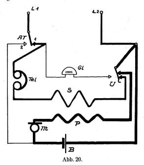
Abb. 20 zeigt diese Schaltung mit abgenommenem Telephon als Prinzipschema. Die Aufhängevorrichtung hat durch das Abnehmen des Telephones umgeschaltet und so den Primärkreis geschlossen. Die dünn ausgezogenen Leitungen sind abgeschaltet worden. Eingeschaltet sind nun aber die Primärleitungen (ganz dick ausgezogen) und die Sekundärleitungen (mittelstark ausgezogen). Die Bezeichnungen entsprechen Schaltbild 19.
