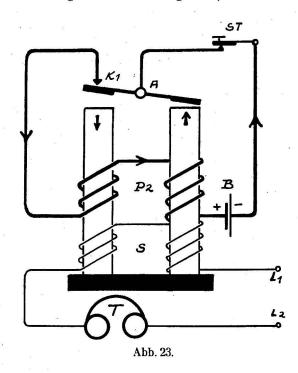
Der Stromfluss in den Spulen P1 ist umgekehrt von P2 und da beide Spulen in gleichem Sinne gewickelt sind, tritt eine Ummagnetisierung ein, der Anker wird jetzt auf der rechten Seite angezogen.
