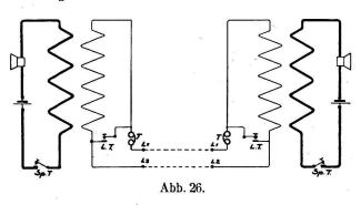
Aus dem Schema ist sofort ersichtlich, dass hier einfach die Sekundärwicklung mit der Lauthörtaste LT kurz geschlossen wird; die Sprechtaste gibt dem Primärkreis Strom. Auf keinen Fall darf hier beim «Sprechen» die Lauthörtaste gedrückt werden, die Gegenstation würde nichts hören!
