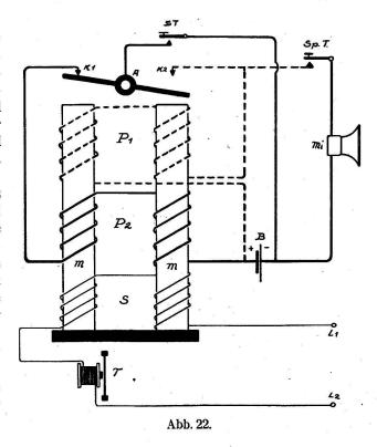
(Mi) muss die Summertaste (ST) losgelassen und dafür die Sprechtaste (Sp. T.) gedrückt werden. Dadurch wird der Primärkreis (P1) mit der Batterie (B) und dem Mikrophon (Mi) geschlossen. Der Stromlauf ist demnach folgender: Batterie —, Mikrophon Mi, Sprechtaste Sp. T., Primärwicklung P1, Batterie + (siehe auch Abb. 13).
