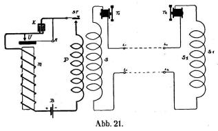
und dieselben Vorgänge wie bei der Gleichstromglocke (Abb. 17) spielen sich ab. K ist ein Kondensator, der den Zweck hat, die Funkenbildung am Unterbrecher U möglichst zu verhindern. In den beiden Telephonen, die ja im Sekundärkreis liegen, wird nun der starke Summton laut zu hören sein.
