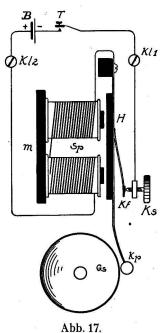
Der Stromverlauf ist folgender: Von der Batterie (B—) zur Taste (T), wird diese geschlossen, fliesst der Strom zur Anschlussklemme Kl 1, der Glocke. Von hier zur Kontaktschraube KS, auf welcher die Kontaktfeder Kf des Hammers H leicht aufliegt. Dann über diese Feder in die Magnetspulen Sp, zurück zur Anschlussklemme Kl 2 und endlich wieder zur Batterie (+). Fliesst
