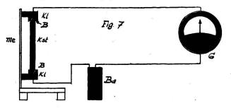
schen diesen beiden Kohlelagern Kl ist ein Kohlenstäbchen Kst so angebracht, dass dessen Spitzen B leicht gegen die Lager gepresst werden, also hier ein elektrischer Kontakt besteht. Zudem wird hier erstmals eine Stromquelle, eine Batterie oder ein Element Ba, eingeschaltet. G ist wieder das Messinstrument.
