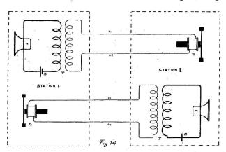
Abb. 14 zeigt diese Ausführung. Es sind zwei getrennte Anlagen, wobei auf Station I das Mikrophon der ersten und das Telephon der zweiten Anlage benützt wird. Auf Station II wird hingegen das Mikrophon der zweiten und das Telephon der ersten Anlage verwendet. Die ganze Anordnung hat noch den grossen Nachteil, dass vier Feld-
