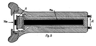
In Abb. 5 ist das Bell'sche Telephon dargestellt. Die Membrane (Me), eine dünne Eisenplatte, ist in zirka 0,5 mm Abstand vom Magnetstab angebracht, so, dass sie frei schwingen kann. S ist die Spule und A bezeichnet die beiden Anschlüsse dazu.
