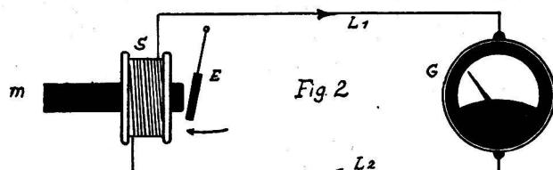
Hier, in Abb. 2, bewegen wir die Eisenplatte nach links gegen den Magneten. Während dieser Bewegung entsteht ein elektrischer Strom, der in einer ganz bestimmten Richtung fließt und das Messinstrument nach einer Seite, hier z. B. nach links, ausschlagen lässt. Die Richtung des Stromflusses in den Leitungsdrähten ist durch Pfeile angegeben.
