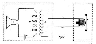
geschickt. Beim Empfänger werden diese Ueberland- oder Feldleitungen direkt der Telephonspule (T) zugeleitet, welche dann ihrerseits die Membrane Me zu Schwingungen anregt.
