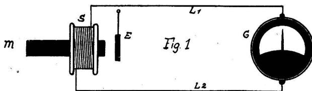
In Abb. 1 sehen wir diese Anordnung. Die Eisenplatte befindet sich im Bereich des Magnetfeldes, aber in der sogenannten Ruhelage.
