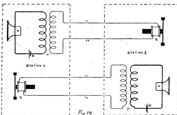
Abb. 14 zeigt diese Ausführung. Es sind zwei getrennte Anlagen, wobei auf Station I das Mikrophon der ersten und das Telefon der zweiten Anlage benutzt wird. Auf Station II wird hingegen das Mikrophon der zweiten und das Telefon der ersten Anlage verwendet. Die ganze Anordnung hat noch den grossen Nachteil, dass vier Feld-
