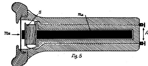
In Abb. 5 ist das Bell'sche Telefon dargestellt. Die Membrane (Me), eine dünne Eisenplatte, ist in zirka 0,5 mm Abstand vom Magnetstab angebracht, so, dass sie frei schwingen kann. S ist die Spule und A bezeichnet die beiden Anschlüsse dazu.
