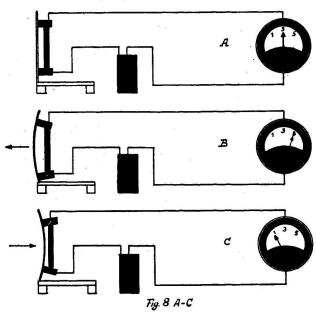
Nehmen wir an, Abb. 8a zeige das Mikrophon unbesprochen, also in der Ruhelage. Jetzt fliesst nur ein Ruhestrom von z. B. 3 mA, dank der angelegten Spannung der Batterie von 1,5—3 Volt. Die Kohlenlager üben in dieser Ruhelage bei den Berührungsstellen B einen ganz bestimmten Druck auf den Kohlenstab Kst aus. Dadurch wird dem Strom eine Brücke geschlossen und eine ganz bestimmte Menge Strom, z. B. 3 mA, hindurchgelassen.
