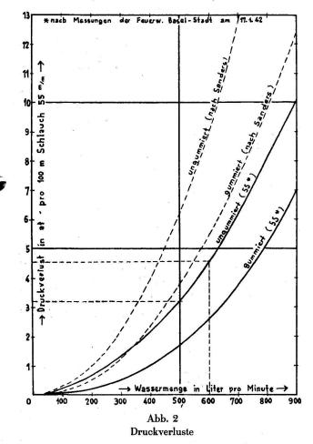
Die Abb. 2 zeigt stark ausgezogen die Druckverlustkurve, wie sie bei Versuchen mit neuen, ungummierten und mit gebrauchten, gummierten Schläuchen mit 55 mm lichter Weite gefunden wurden. Dünn ausgezogen sind Werte aufgetragen, wie sie von Ing. Sanders veröffentlicht wurden.
