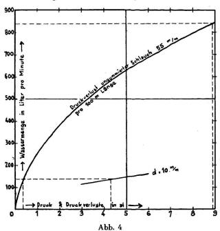
Wassermengen und Druckverluste
