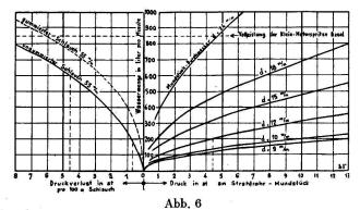
Druck- und Durchfluss-Verhältnisse am Strahlrohr nach Messungen der Feuerwehr Baselstadt am 17 Januar 1942.
