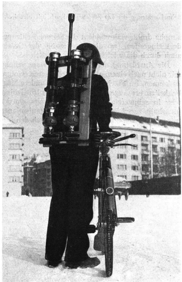
Schnelllöschtrupp der LO Zürich (Hydrantengarnitur)
