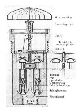
Abb. 3. Allseitig empfindlicher Doppel-Aufschlagzünder für Brisanzbomben mit Windradsicherung.
