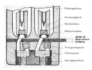
Abb. 4. Anordnung der Doppelzündkanäle für Momentund Verzögerungszündung.
