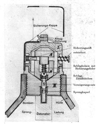
Abb. 1. «Allseits»-Zünder für Sprengbomben (ineinander verschiebbares Doppelkonus-Aggregat).
