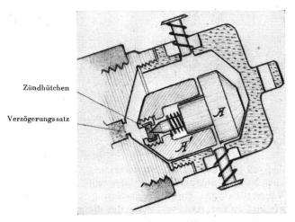
Abb. 2. Funktion des «Allseits»-Zünders bei fast waagrechtem Aufschlag.
