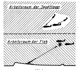
Abb. 4. Zonenabgrenzung in der Horizontalen nach der Wirkungshöhe der Flab.
