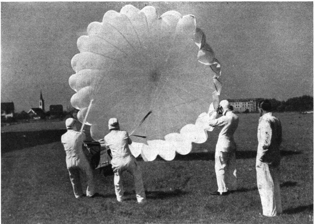
Der Fallschirm wird heute nicht nur für die Rettung von Fliegern verwendet. In fast allen Kriegsländern bestehen ganze Heereseinheiten von Fallschirmabspringern. Sie gehören zu den Elitetruppen des Héeres. Der Fallschirm besteht aus 18—24 Reissbahnen, diese werden aber nicht gerade, sondern diagonal geschnitten, um die Festigkeit zu erhöhen. Vom Ende des Schirmes führen je nach Art 18—24 dünne Seile zum breiten Traggurt, der den Körper des Fliegers fest umschliesst.
