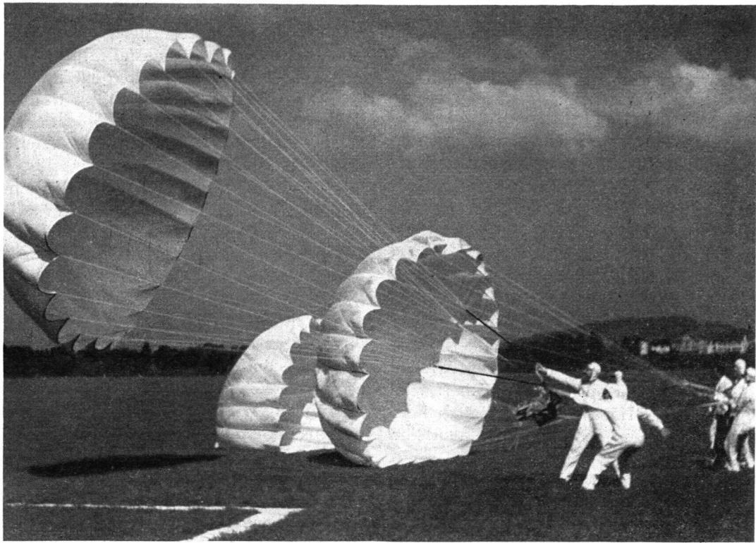
Wieder auf der Erde. Im Moment der Landung muss der Schirm raschestens eingezogen werden, weil er sonst wie ein riesiges Segel weiter treibt und den Springer nach sich zieht. Der Fallschirm wird aus leichter, besonders widerstandsfähiger Seide oder Baumwolle hergestellt. Er wird aus 20—24 Bahnen fest zusammengenäht und durch Quernähte verstift. Der Durchmesser beträgt 7- 8 Meter, die Oberfläche etwa 40—55 Quadratmeter, das Gewicht rund 8 Kilo.
