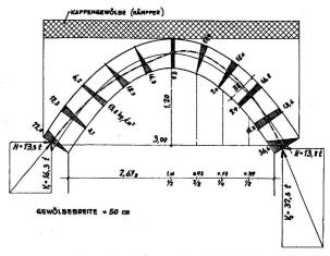
Spannungsnachweis eines maximal belasteten Gewölbes nach der Stützlinienmethode. Der Gurtbogen, 50 cm breit und 38 cm hoch, ist als Stützliniengewölbe für Eigengewicht und die halbe Trümmerlast geformt.
