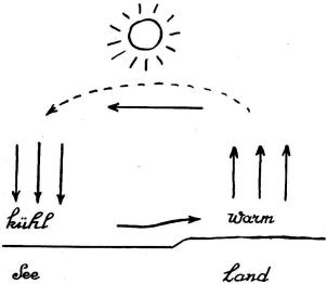
Abb. 1. Wärmeströmungen infolge ungleicher Erwärmung der Erdoberfläche.
