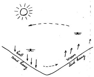
Abb. 3. Einfluss der Bodenform auf die Wärmeströmungen.
