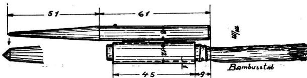
Die Abbildung zeigt die aus Silberstahl hergestellte Spitz mit angeschweisstem, beidseitig offenem, blank gezogenem Stahlrohr. Das Ganze ist nach der Härtung mit der Bürste blank poliert und damit weitgehend rost sicher gemacht.
