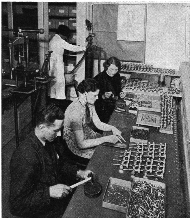
Abb. 4 FEGA-Fabrikation von Sauerstoff- Flaschenventilen und Druckreduzier- ventilen
