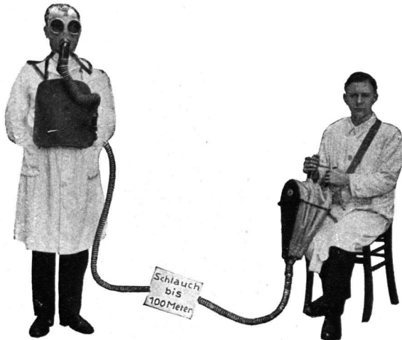
Abb. 3. Druckschlauchgerät mit Blasebalg.
