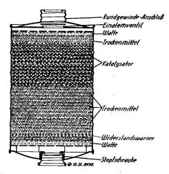
Abb. 1. Dräger-Kohlenoxydfilter: Schnitt.
