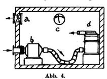
Schematische Darstellung einer Gasschutzanlage mit Verwendung eines Staubsaugers. a = selbstregelnde Luftklappe, b = Filter, c = Druckmesser, d = Staubsauger.
