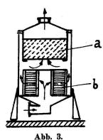
Schematische Darstellung eines Raumfilters. a = Gasfilter, b = Nebelfilter.
