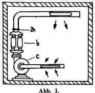
Schematische Darstellung einer Kreislaufventilation. a = Einstellschieber, b = Patronen, c = Ventilator.
