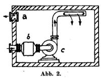
Schematische Darstellung einer Durchflussventilation a=selbstregelnde Luftklappe, b=Filter, c=Ventilator.
