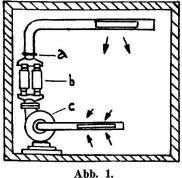
Schematische Darstellung einer Kreislaufventilation. a = Einstellschieber, b = Patronen, c = Ventilator.
