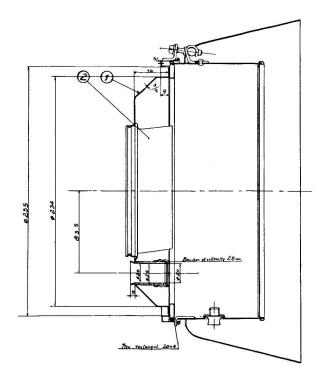
Abb. 5. Verdunkelungseinrichtung Galley (Scheinwerfer von Strassenbahnen).
