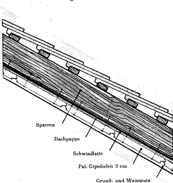
Den bereits bekannt gewordenen technischen Richtlinien zum Schutze der Bauten gegen Brandbomben durch konstruktive Vorkehrungen kann man entnehmen, dass die Verwendung des Holzes für Dachkonstruktionen und Balkenlagen für die Zukunft nicht zu empfehlen ist. Nehmen wir auch an, dass beim künftigen Hausbau die Verwendung von Holz tatsächlich ausgeschlossen würde, so hätten wir doch zufolge der bisherigen Bauweise noch auf Jahrzehnte hinaus einen Häuserbestand,
