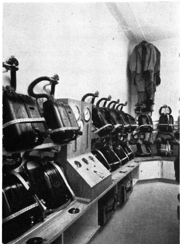
Geräteraum. Lagerung der Sauerstoffgeräte und Dräger-Grossdichtprüfanlage. Die neben dem Dichtprüfer gelagerten acht Geräte können direkt angeschlossen und geprüft werden. Man beachte die zwangslose Lage der Atemschläuche. Unten: Schränke und Regale für Kalipatronen, Sauerstoff-Flaschen und Werkzeugkasten. An der Decke das Traggestell für die Yperitkleider.
