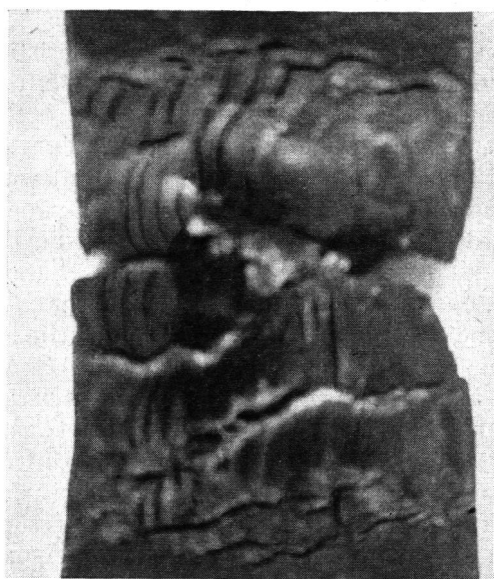
Fig. 6. Unterseite des imprägnierten Brettes nach 37 Minuten Brenndauer.
