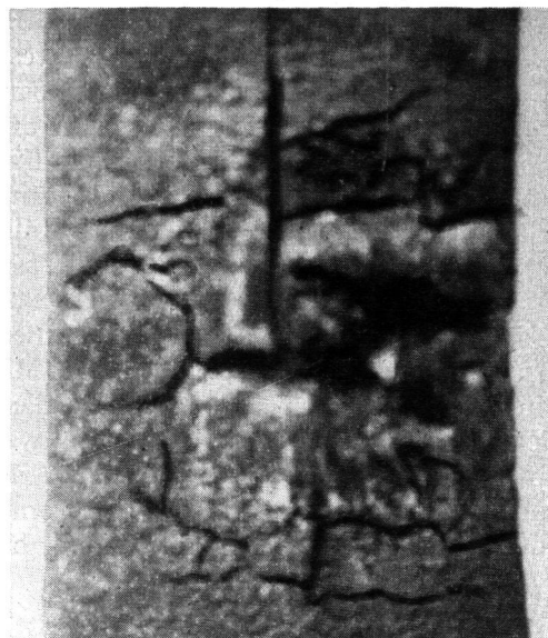
Fig. 7. Brettunterseite mit Anstrich nach 22 Minuten Brenndauer
