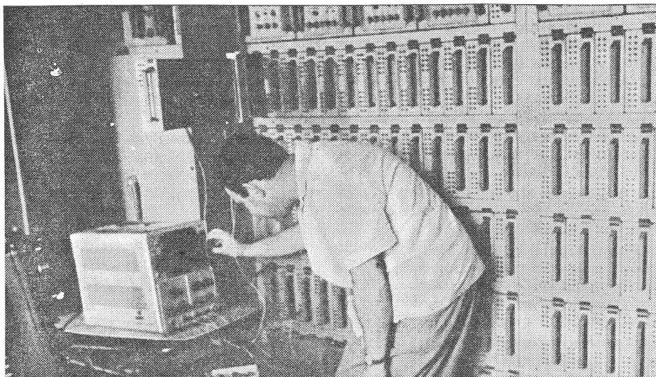
Der sowjetische Computer Rasdan-3 kann in einer Sekunde 200 Zeichen lesen und in seinem Gedächtnis 22 Millionen Zeichen speichern.
