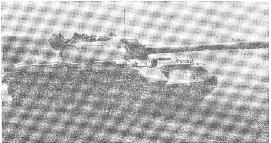
Der sowjetische Panzer T 54 in der Ausführung von 1955 (Bild oben). Er stellt die Standardausrüstung der mittleren Panzerregimenter seit 1955 dar. Gefechtsmasse: 36 Tonnen; Besatzung: 4 Mann; Länge: 600 cm; Breite: 328 cm; Höhe: 240 cm; Bewaffnung: 100-mm-Bordkanone L/54, FlaMG 12,7 mm auf Ladeschützenkuppel; Dieselmotor mit 520 PS. Der Panzer ist mit Tiefwateneinrichtung und Infrarotgeräten versehen.
