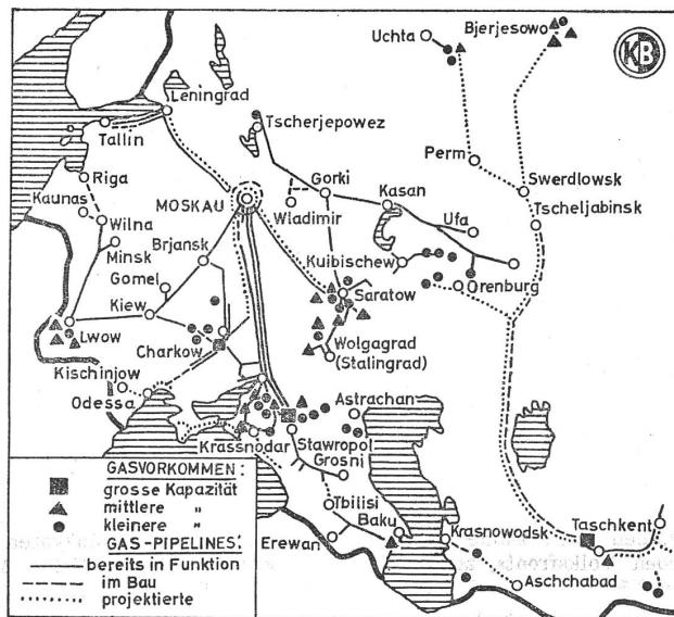
Für dieses Jahr 1962 gilt die besondere Anstrengung der Leitung, welche von Buchar (südwestlich von Taschkent in Usbekistan) bis Tscheljabinsk (Ural) führt. Man rechnet innerhalb Jahresfrist mit einer Transportkapazität von mehr als einer Milliarde Kubikmetern.
