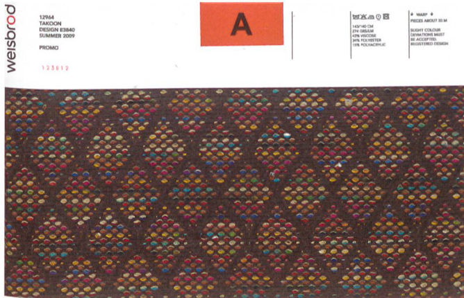
Abb.15 Archiv-Nr.283: Jacquardgewebe, Leinwandbindung, Ripsbindung, Lancé. Materialmischung (42 % Viskose, 34 % Polyester, 15 % Polyacryl [sic! Angabe auf der Liasse]), 2009.
