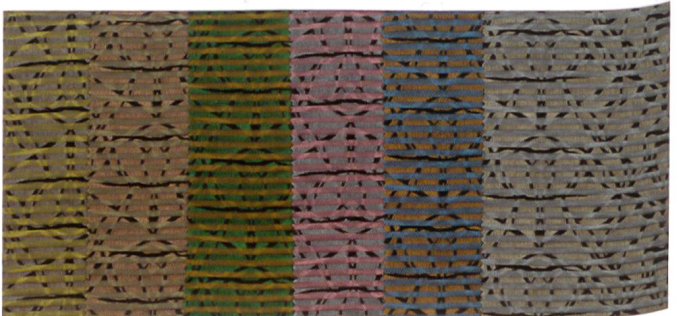
Abb.8 Archiv-Nr.311: Jacquardgewebe, Leinwandbindung, Atlasbindung, Plisseé. Materialmischung (58 % Acetat, 26 % Baumwolle, 16 % Seide), 2005/06.
