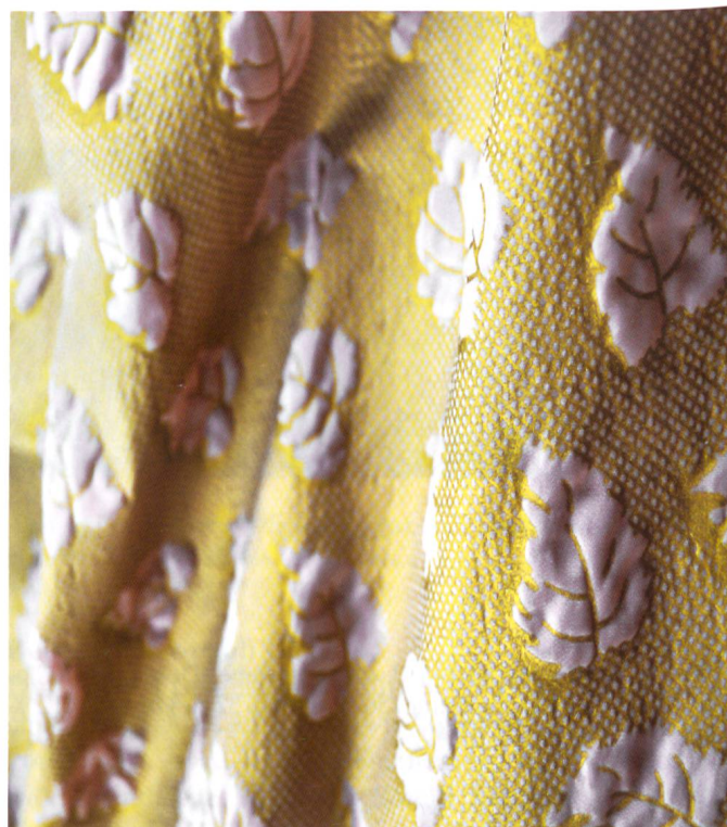
Abb.23,24 Archiv-Nr.351: Schafsgewebe, Leinwandbindung, Druck. Nylon (Polyamid), ca. 1940.
