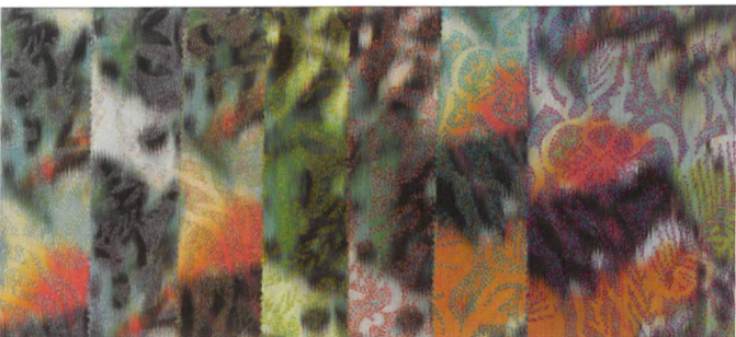
Abb.5 Archiv-Nr.266: Jacquardgewebe, Atlasbindung, Kett- druck. Materialmischung (62 % Acetat, 38 % Polyester), 2006.
