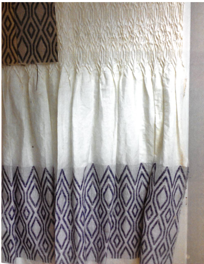
Abb. 9, 10 Archiv-Nr. 271: Jacquardgewebe, Leinwandbindung, Lancé, Piqué, Plissee. Materialmischung (40 % Leinen, 30 % Baumwolle, 20 % Acetat, 9 % Polyamid, 1 % Elastan), 2008.
