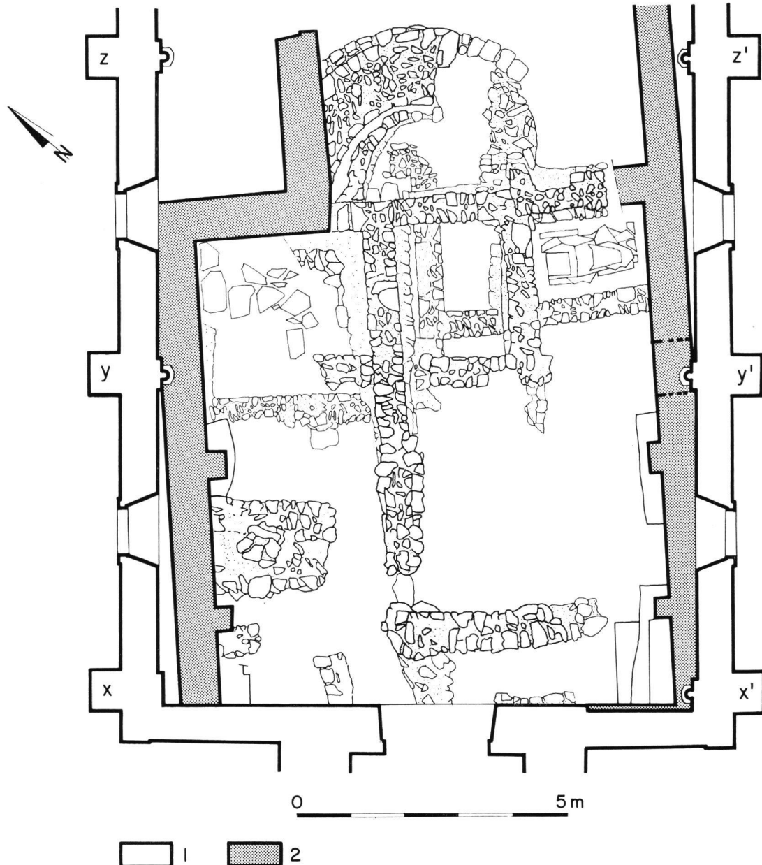
Fig. 4 Maçonneries découvertes sous l'église du XVII e siècle (pierre à pierre). 1: église actuelle; 2: vestiges de l'église du XVII e siècle (voir aussi fig. 5-6)
