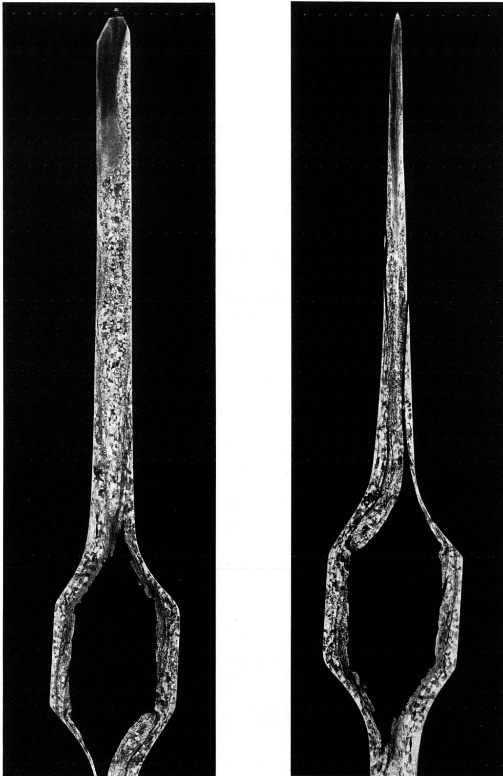
a und b . «Zürcher Halbarte», Querschnitt, geätzt; man beachte die Überlappungen und die Verschiedenheit des Metallgefüges. Grösse ca. 2:1
