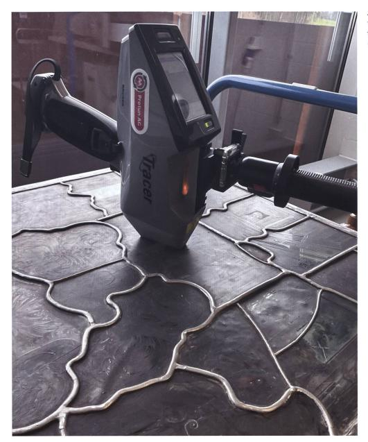
Abb. 7 Rotlotanalyse mit transportablem Röntgen-fluoreszenzspektrometer (Tracer 5 g, Bruker).
