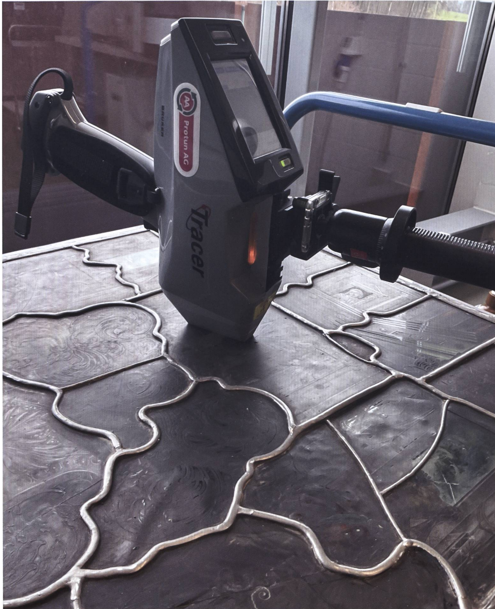
Abb. 7 Rotlotanalyse mit transportablem Röntgenfluoreszenzspektrometer (Tracer 5 g, Bruker).
