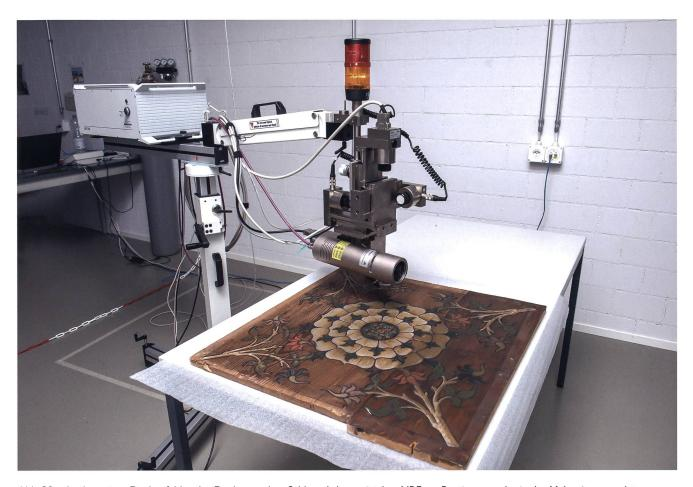
Abb. 38 Analyse eines Deckenfeldes der Decke aus dem Schloss Arbon mittels  $\mu$ -XRF zur Bestimmung der in der Malerei verwendeten Pigmente. Sammlungszentrum, Affoltern am Albis.
