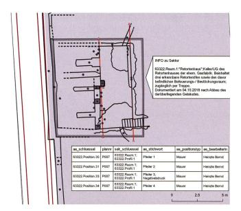
Abb. II Chur GR, Steinbruchstrasse (Überbauung Alter Forstwerkhof). Auf dieser Grabung wurden die Retortenöfen einer ehemaligen Gasfabrik dokumentiert. Im Geografischen Informationssystem werden die wesentlichen Befund-Geometrien aus der CAD-Zeichnung und die Beschreibungen aus IMDAS zusammengeführt.
