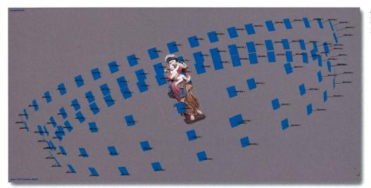
Abb. 16 Martin Stollenwerk, Zürich: Fotogrammetrische 3D-Vermessung einer Plastik.
