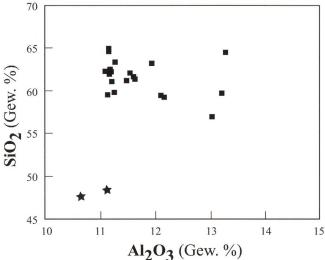
Abb. 10 Geschirr- und Ofenkachel-Fayencen aus den Manufakturen Freiburg (oben) und Winterthur (unten) im binären Diagramm  $SiO_2$ -Al $_2O_3$ . Symbole wie in Abbildung 8.
