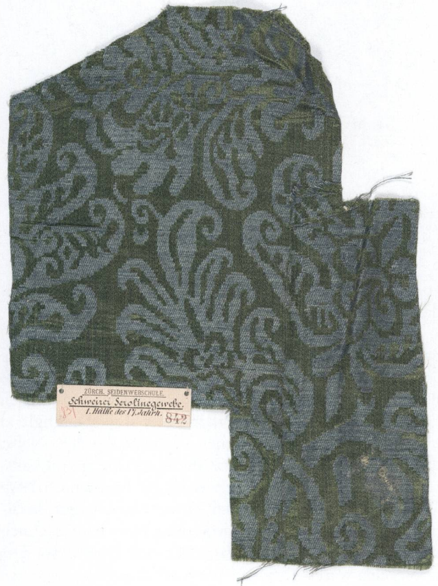
Abb. 46 Serolinegewebe, erste Hälfte 17. Jh. Kette: Seide, Schuss: Leinen, Atlasbindung. Gewebesammlung der Schweizerischen Textilfachschule STF, LM I23512.
