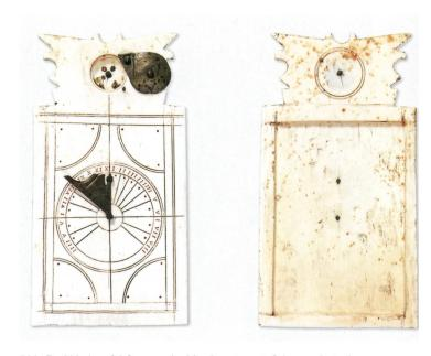
Abb. 7 Wachstafel-Sonnenuhr, Vorderseite mit Schattendreieck, Zifferblatt und Kompass, Rückseite mit Aussparung für Wachsbeschichtung, erste Hälfte 15. Jahrhundert. Germanisches Nationalmuseum Nürnberg, Inv.-Nr. WI 355.
